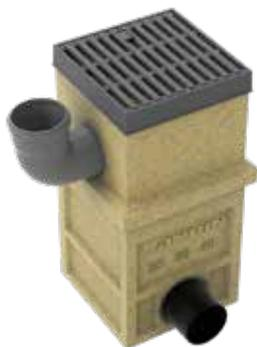
Kombination von Punkteinlauf mit Aufsatzkasten, mit Guss- Längsstabrost, sowie den Anschlüssen von Regenfallrohr und Rohranschluss.
