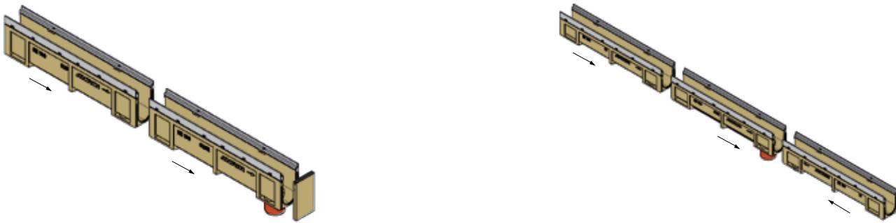
2. Einbau eines Einlaufkastens am Ende oder in der Mitte eines Rinnenstranges.
