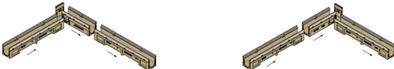
4. T-Verbindung mit mittiger Anordnung des Rinnenelementes mit Vorformung für Anschlussmöglichkeit.
