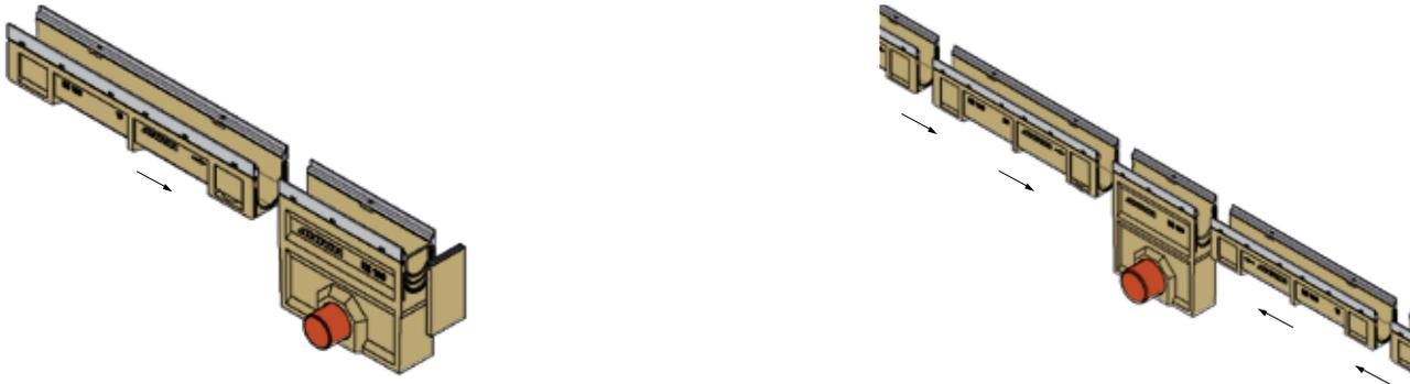
3. Eckverbindung mit Rinnenelement mit seitlichen Vorformungen. Einbau im ankommenden oder abgehenden Schenkel des Rinnenstranges möglich.
