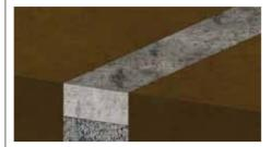
Betonbett aus 3 Teile Sand + 1 Teil Wasser + 1 Teil Zement, auf Tragschicht aufbauen.
